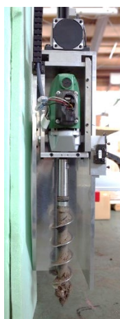
写真2 穴開け条件の試験機
