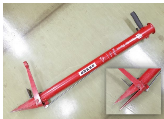
写真3 プランティングチューブ 筒の先が図右下のように開いて苗を植える
