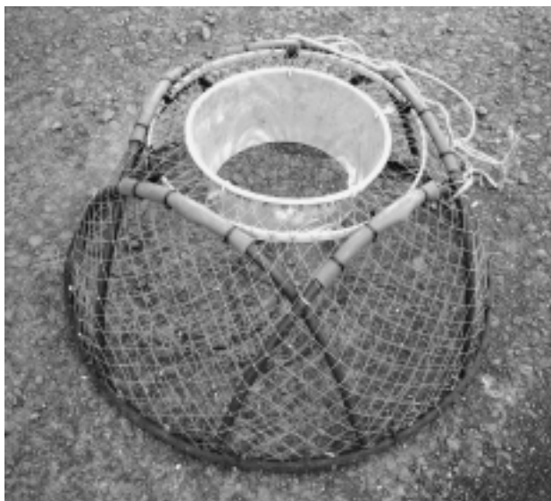
図1 調査に用いたかご かご枠：下枠経90cm, 上枠経32cm, 高さ40cm ろ斗：上口経32cm, 下口経26cm, 高さ15cm
