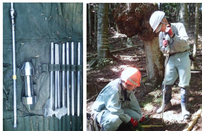
図21. 簡易貫入試験器具と試験の様子
