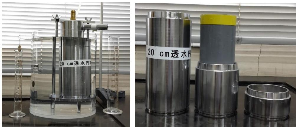
図 5.7-2 左：室内透水試験装置（定水位）、右：コア径に合わせて制作した透水円筒
