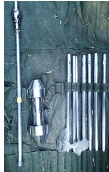
図 5.5-2 簡易貫入試験器具
