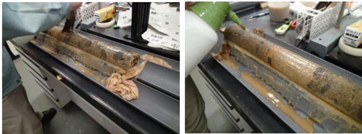
図 5.6-3 霧吹きと刷毛による洗浄作業の様子
