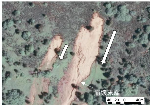
図4.2-20 崩壊地の平面形状
