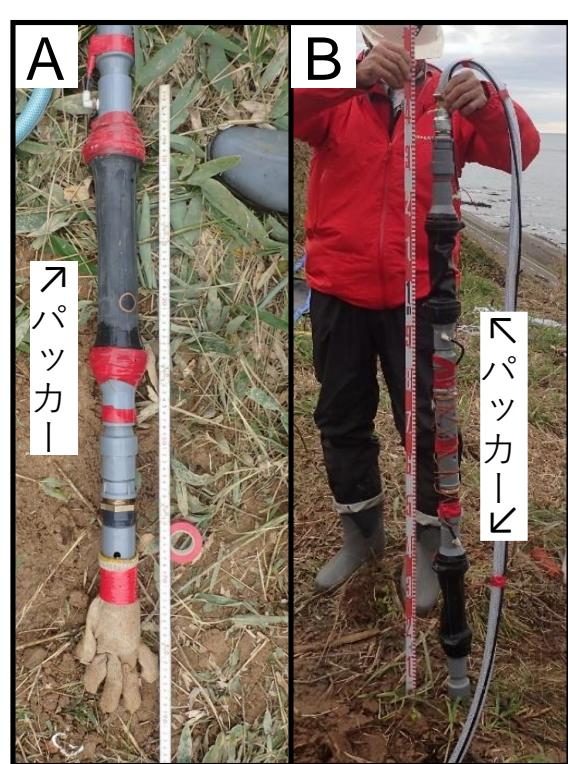
図 5.5-11 原位置透水試験装置(左)とパッカー(右)
