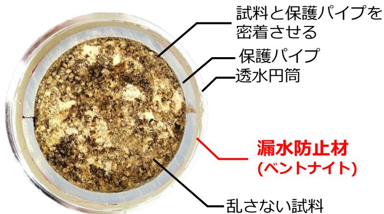
図 5.7-1 自立が困難な試料における供試体の作製例(断面図)
