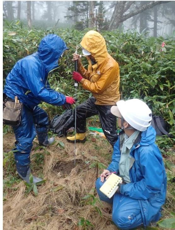
図 5.5-8 ベーンコーンせん断試験実施状況
