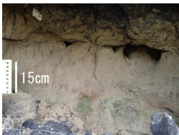
図 4.2-25 周氷河堆積物と Ta-d まじり土層の境界に生じたパイピング孔
