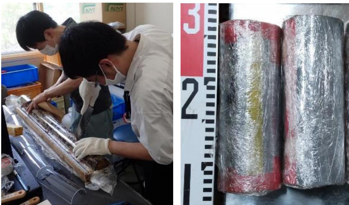
図 5.7-6 供試体の作製作業と塩ビ管で保持した試料
