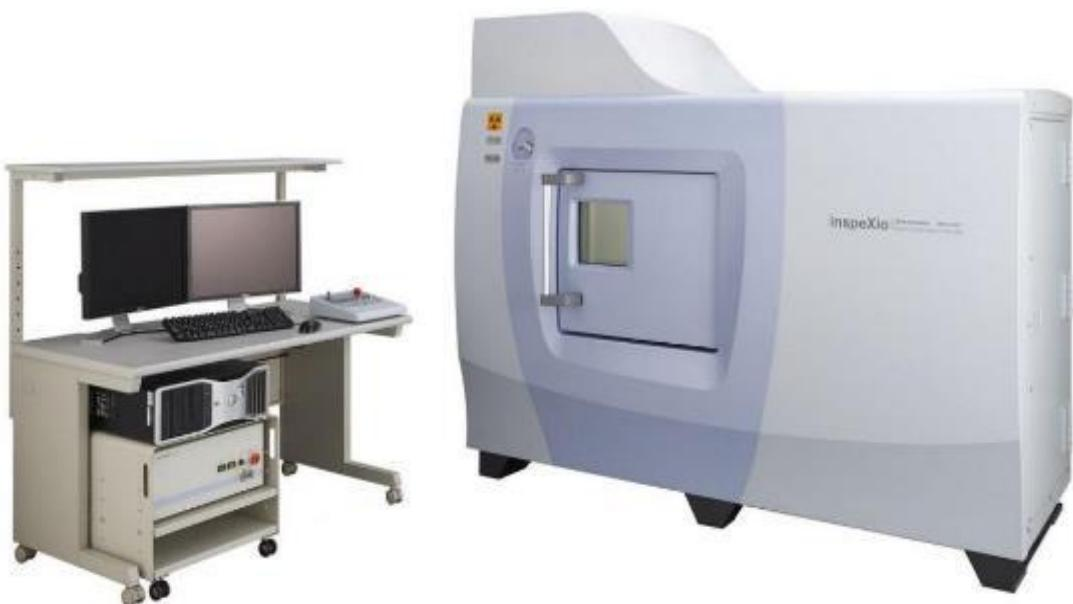
図 5.7-5 X 線 CT 装置(inspeXio SMX-225CT: 北海道立総合研究機構 所有)
