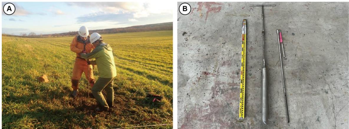
図 5.4-1 A: 小径掘削調査、B: 小径掘削に用いる調査器材(中央: ハンドコアラー、右: 検土杖)
