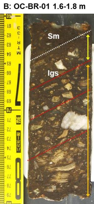
図資料 3.2-4 落合地区(粘板岩・片岩)の周氷河堆積物のスラブ写真
