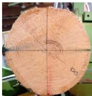
写真8 末口面のアテ（褐色部）
