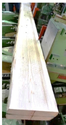
写真4 製材された木材 （筋状の褐色部がアテ）
