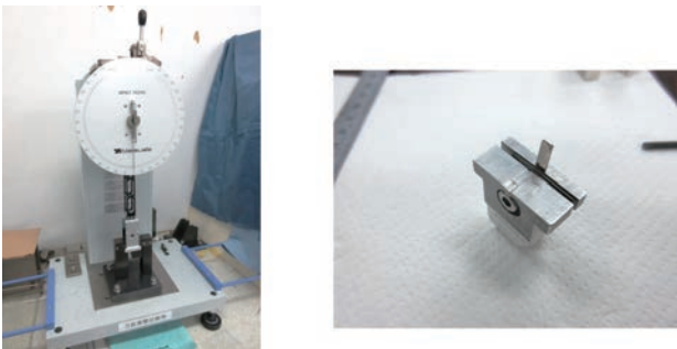
図 2 アイゾット衝撃試験機（左）と試験用ジグ（右）
