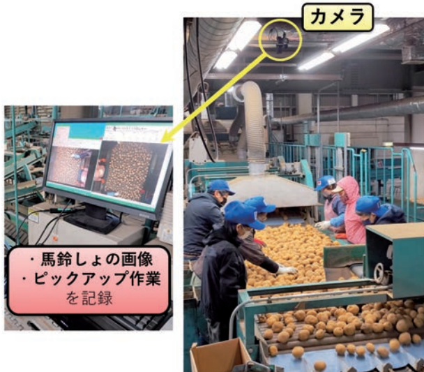
図11 馬鈴しょの撮像と規格外品の抽出
