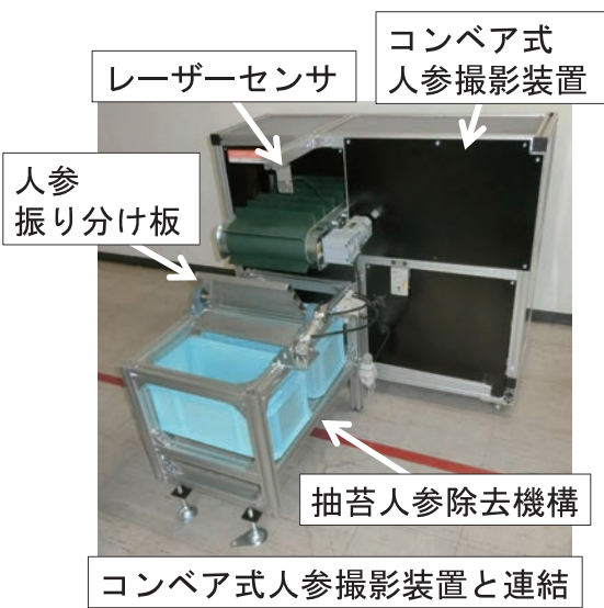
図10 開発した抽苔人参除去機構
