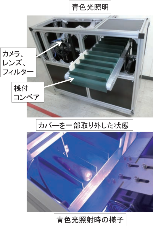
図8 開発したコンベア式人参撮影装置
