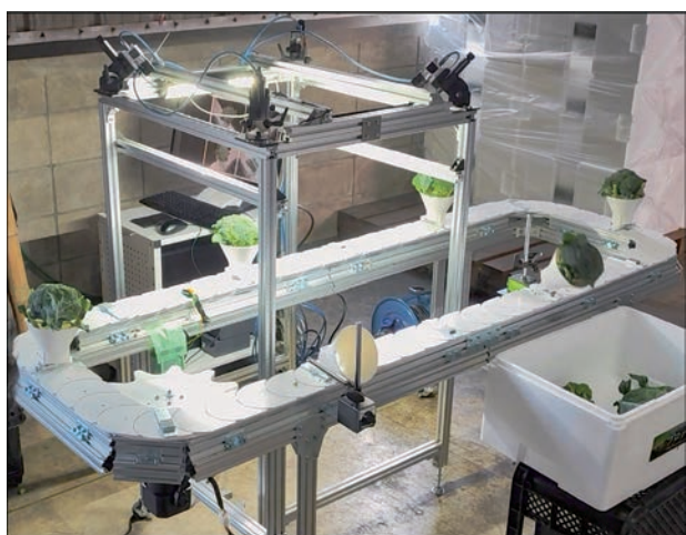
図8 ブロッコリー自動品質検査装置の試作機
