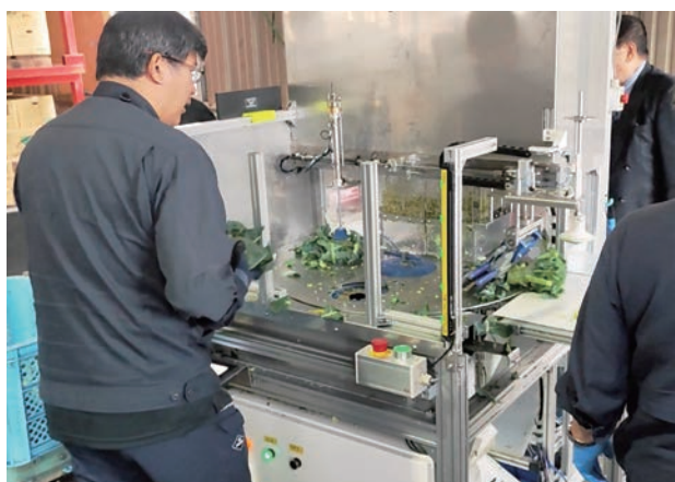
図9 開発中のブロッコリー自動検査茎葉除去装置
