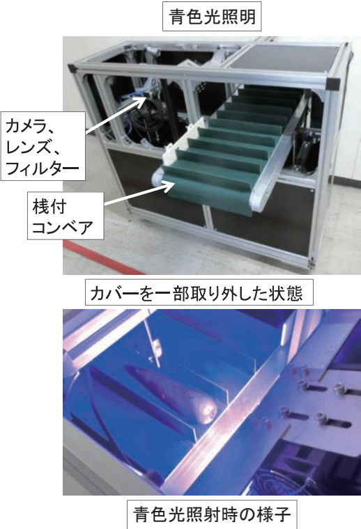
図8 開発したコンベア式人参撮影装置
