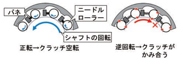
図9 ワンウェイクラッチの動作原理
