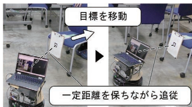
図4 ARマーカーに向かって追従する自律移動台車
