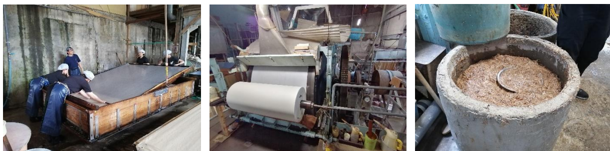
写真-1 手漉きと機械漉きの和紙生産、機械漉きに使うノリウツギの「ネリ」
