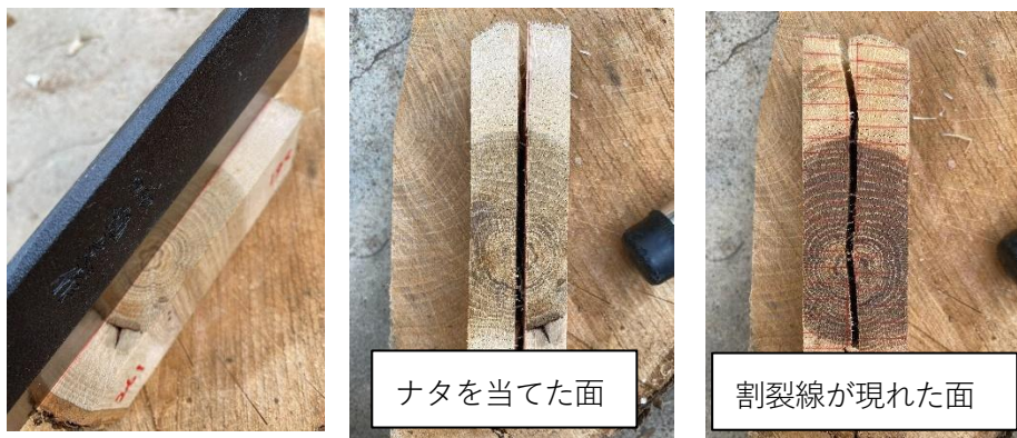
図 3. 割裂法の様子。サンプルの木口面（表裏）に平行に引いた基準線にナタを当て、繊維に沿って割る。繊維が傾斜した部分の割裂線は、基準線からずれて現れる。ずれの大きさが、材のねじれの大きさを表す。
