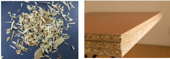
写真2 パーティクルボードの例 (左:原料, 右:表面に化粧シートを貼ったボード)
