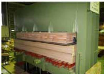
【カラマツ CLT の製造試験】
