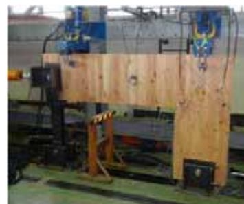
【大型パネル性能試験】
