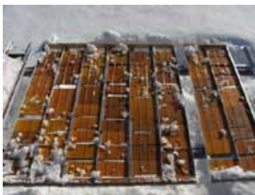
【アセチル化木材の塗装耐候試験】
