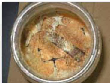
腐朽処理後の状態
