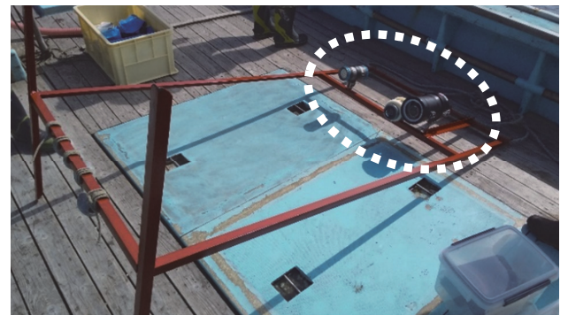
図3 撮影装置。破線は撮影機材（右の2つ）、照明機材（左）を示す。実際は写真左側のフレームが海底に接地。
