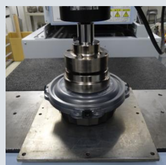
テイクアウト容器の圧縮試験
