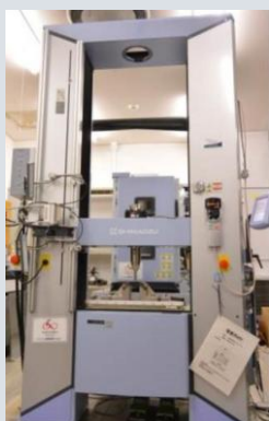
治具を取り替えることで引張・圧縮試験が可能な万能材料試験機
