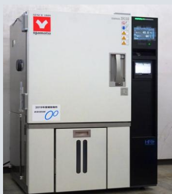
温度と湿度を調節し製品評価が可能な恒温恒湿器
