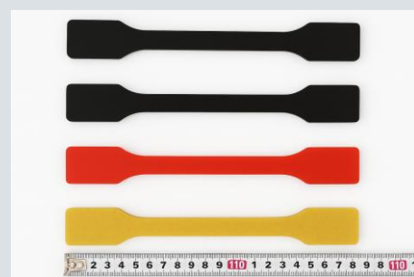
プラスチック試験片の作製
