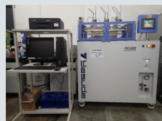
耐熱性試験 (JIS K7191, JIS K7206)
