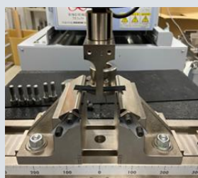
引張試験(JIS K7161等) 曲げ試験(JIS K7171等)
