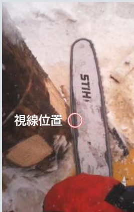
チェーンソー作業における視線計測例
