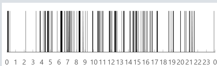
キッチンに設置した人感センサの反応例
