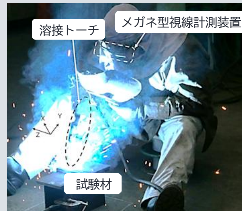
溶接作業における視線計測例
