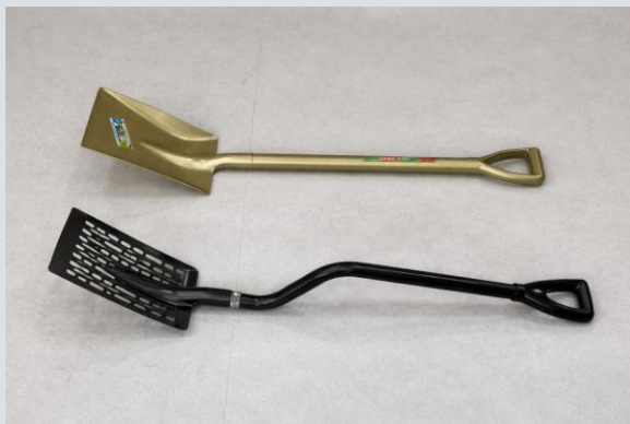
開発したショベルが楽に作業できるかを評価 (上：従来品 下：試作品)
