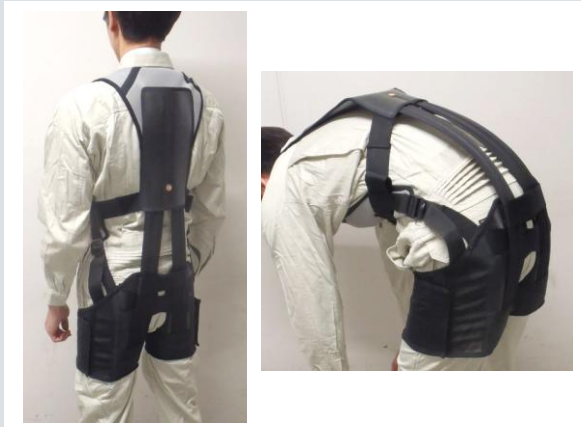
前屈み作業用アシストスーツ (昆布干し、キャベツ収穫など)
