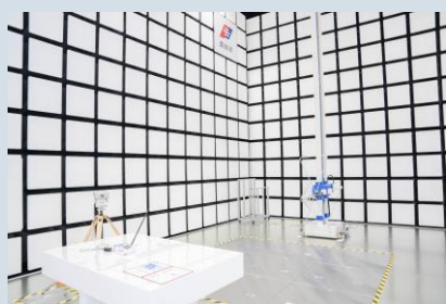
電波暗室・シールドルーム
