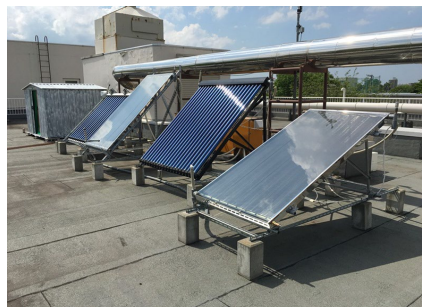
図2 試験設備(太陽熱の能力評価)
