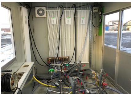
図1 試験設備(地下水熱の能力評価)
