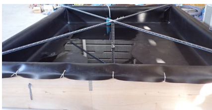
図2 試験用蓄熱池の外観 (実機の 1/1000 スケール)
