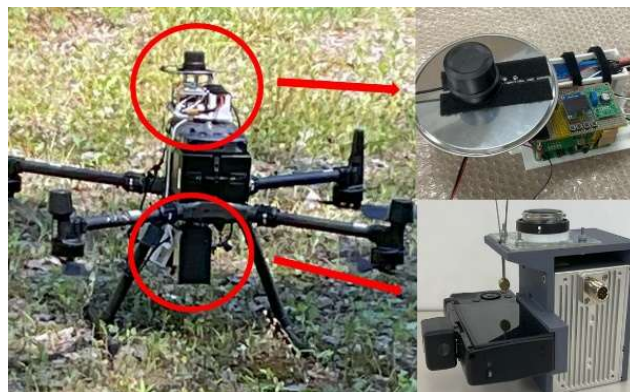
図 2 UAV 搭載型 DEM 計測機器の外観
