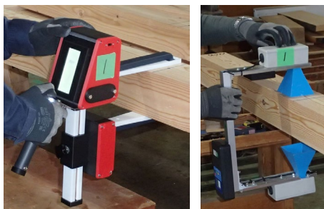
写真1 マイクロ波式含水率計
