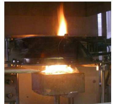
写真1 発熱性試験の様子
