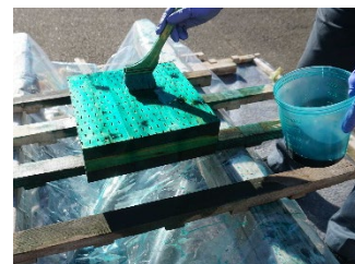
写真4 処理時の様子 (左:加圧処理、右:塗布処理)
