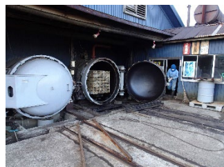
写真4 処理時の様子 (左:加圧処理、右:塗布処理)
