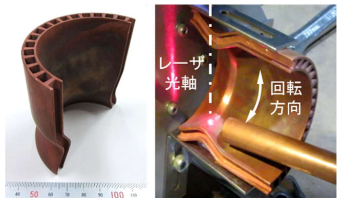
図3 エンジンノズルの半割模擬部品（左） およびレーザー熱処理実験の状況（右）
