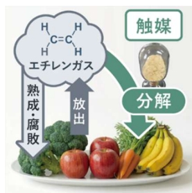
図1 触媒を用いたエチレン除去による鮮度保持技術
