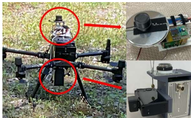
図 2 UAV 搭載型 DEM 計測機器の外観
