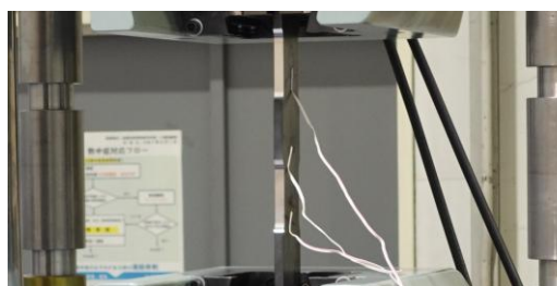
破壊試験（引張荷重）
