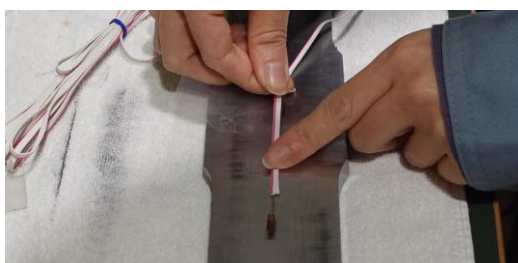
実習（ひずみゲージの貼付け作業）
