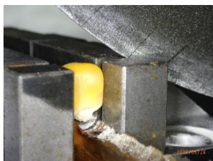
試料高速切断装置による切断の様子および切断面
