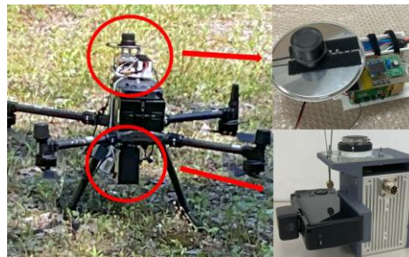
図2 UAV搭載型DEM計測機器
