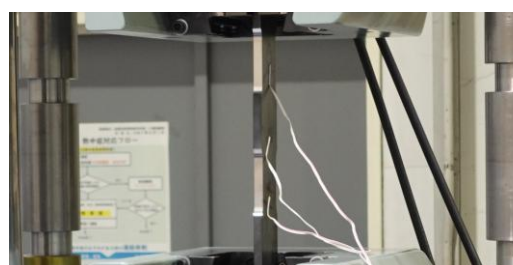
破壊試験（引張荷重）
