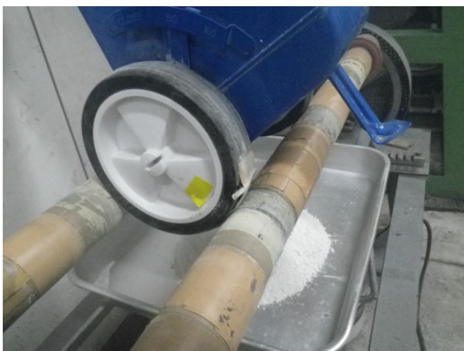
ライン引き機からの排出性能評価
