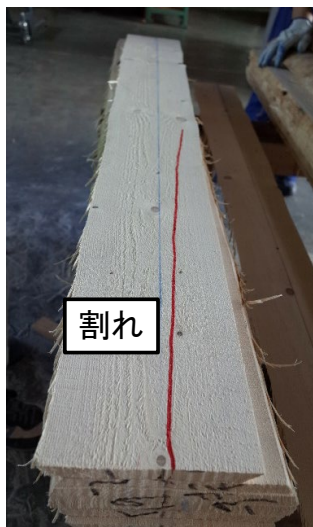
写真2 アカエゾマツ製材時の割れ
