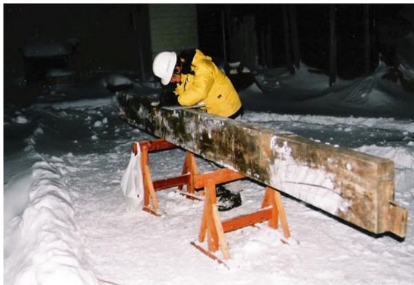
写真1 解体された梁材の形状調査
