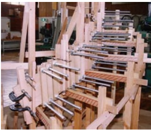
写真6 側板の積層, 接着
