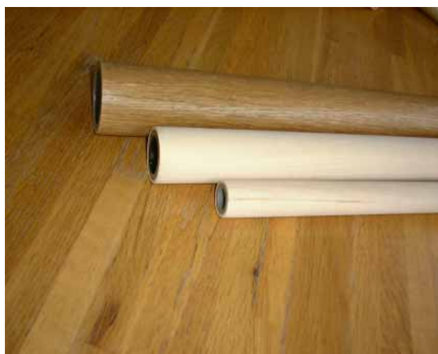
写真5 木材・金属複合パイプの完成例
