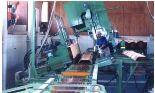
写真1 傾斜型送材車付帯鋸盤による製材
