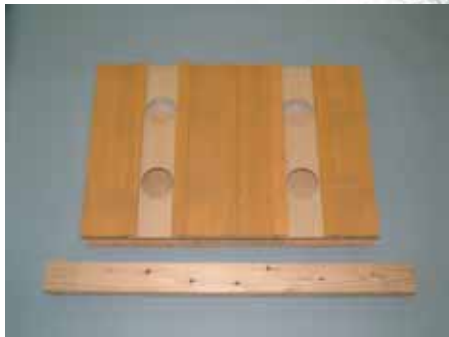
・土台に壁パネルを落とし込む
