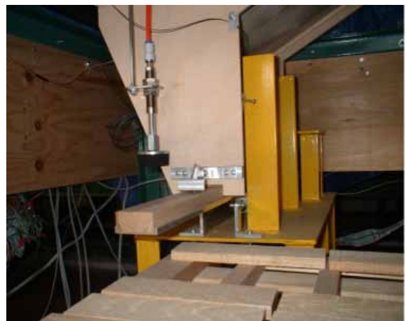
写真2 試作した棧木配置装置
