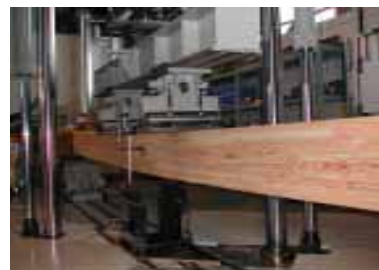
写真5 実大曲げ強度試験
