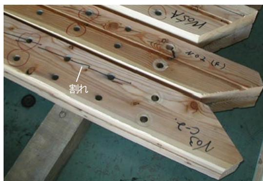
写真1 乾燥により生じた接合部の割れの状況
