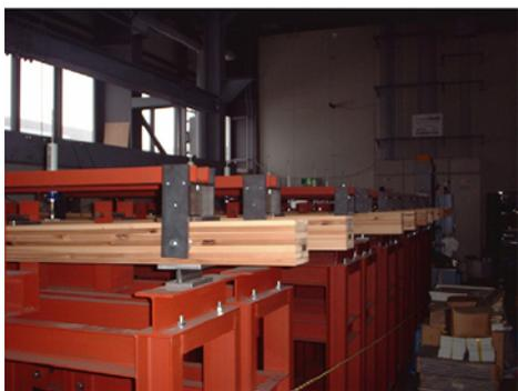
構造用集成材の長期強度性能試験
