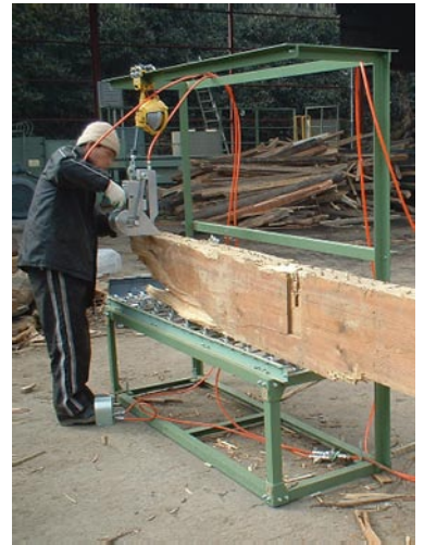
写真4 釘抜き装置による作業
