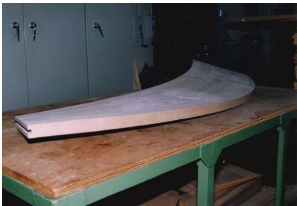
写真 2 製造したらせんすべり台のすべり面
