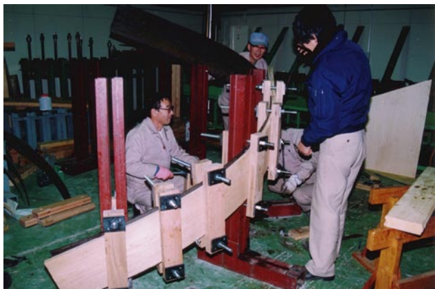
写真1 一般的ならせん形積層材の製造方法の例
