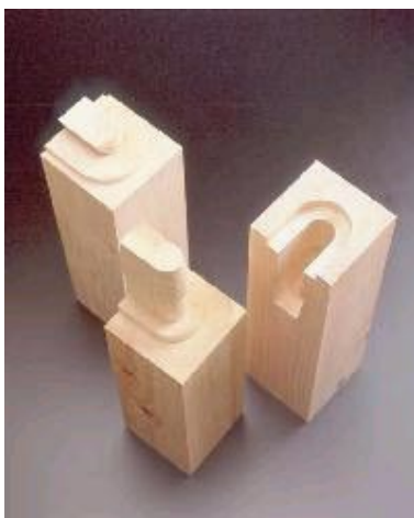
写真 7 プレカット部材の仕口
