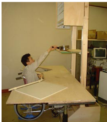
写真3 棚からの取り出し動作確認
