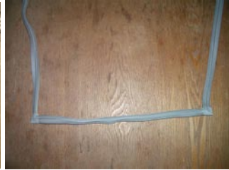
写真17 角を溶着した気密材
