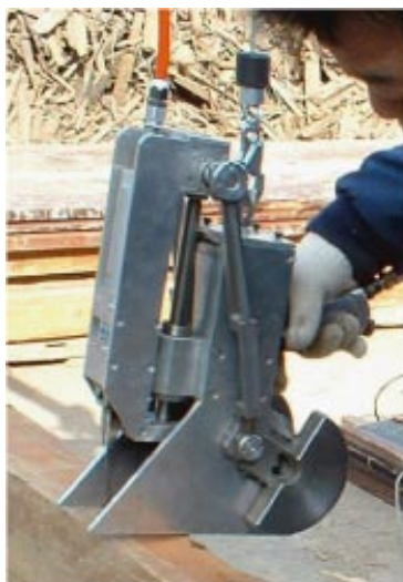
写真1 開発した釘抜き装置
