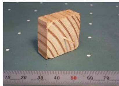
軸（直径1mm長さ10mm）の削り出し
