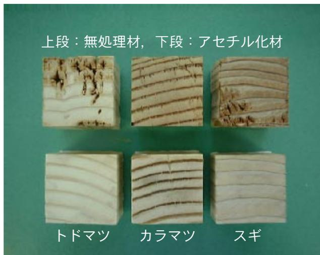
写真1 道産針葉樹材のアセチル化による耐久性向上の一例
