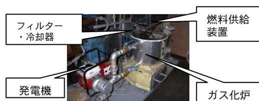
写真2 ダウンドラフト型ガス化炉
