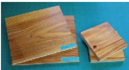
写真2 熱水処理+溶媒置換法によって作られたカラマツ WPC
