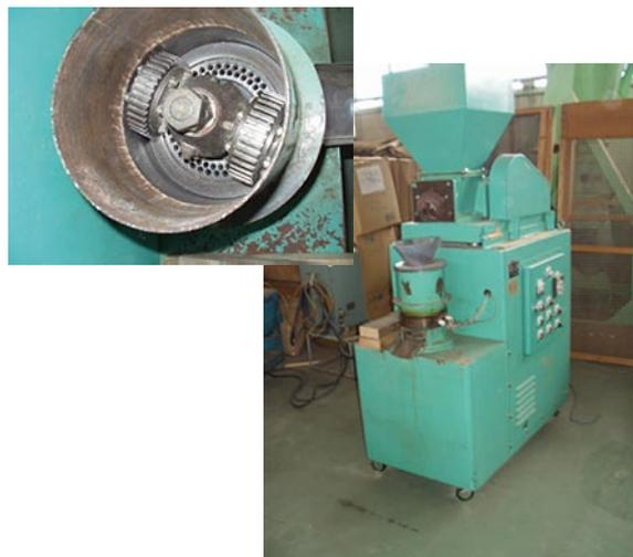
写真6 ディスクダイ型ペレット製造装置
