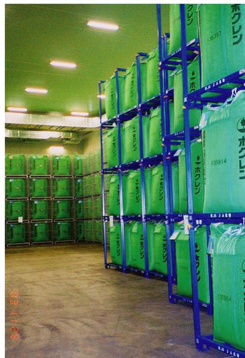
写真 2 フレコンを段積みした様子
