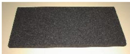
写真7 木質熱処理物と機能性セラミックスの複合成形物
