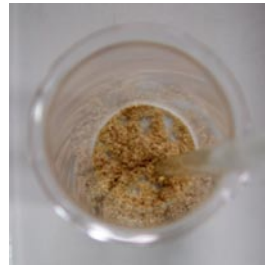
写真 左：CCA 処理木粉，右：濃硫酸により液化した木粉
