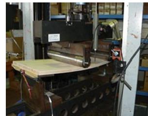
写真4 依頼試験による合板の曲げ試験
