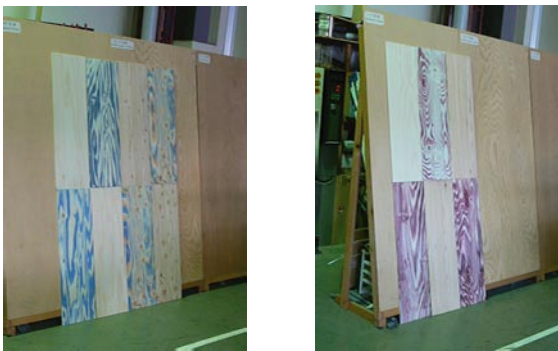
写真2 製作した浮造り合板（左：寒色系、右：暖色系）
