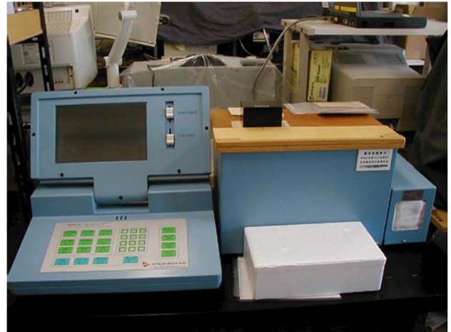
写真 6 カラーコンピュータによる色差の測定
