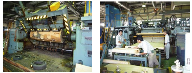
写真3 ローターレースによる単板切削
