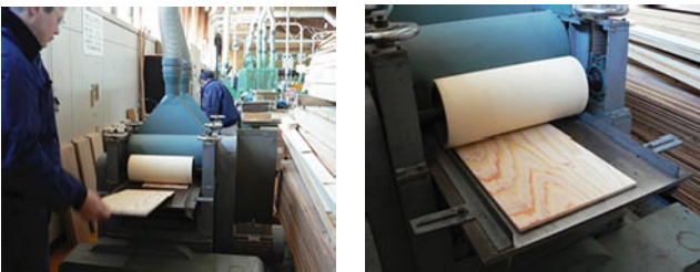
写真1 グリッドサンダー（ブラシ）による浮造り加工
