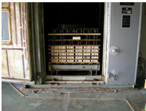
集成材用ラミナの乾燥試験
