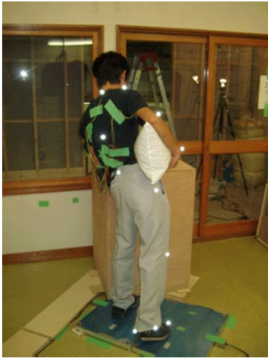
写真3 筋電位測定の様子
