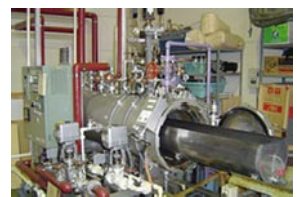
加圧注入装置
