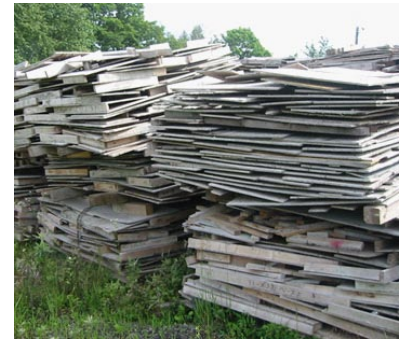
写真1 使用済みコンクリート型枠用合板
