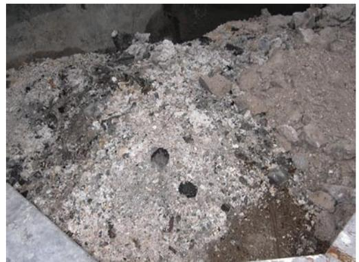
写真3 木屑だきボイラーの燃焼灰
