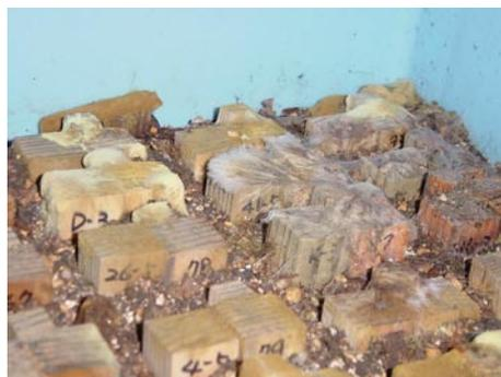
フアンガスセラーによる促進劣化試験
