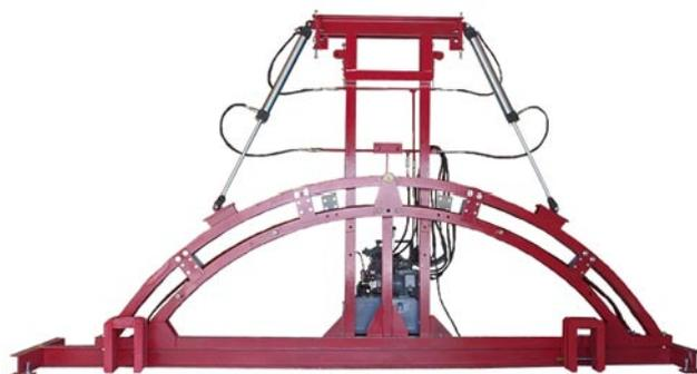
剤を塗って重ねた数枚の板材を真っすぐな状態のまま、目的のわん曲形状を持った鉄製のフレームの上に乗せます。そして、その上から同じ形のフレームを油圧式のアームによって挟み込みながら、一気に曲げて作ります。また、挟み込んだ後は、フレームの内部に設置した耐圧ホースに空気を送ることで、板材全体に均一な力がかかり、完全に接着させることができます。この方法により、これまでのように、いくつもの圧縮装置をひとつひとつ締めながら曲げていく、といった作業がなくなり、品質が安定したわん曲集成材をスピーディーに製造できるようになります。
