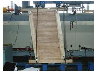
実大試験による性能評価
