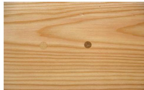
写真5 透明塗装による仕上げ
