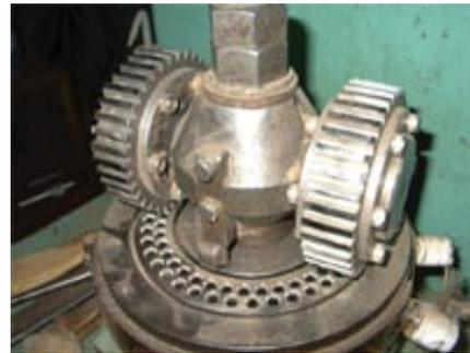
写真2 ペレット製造装置
