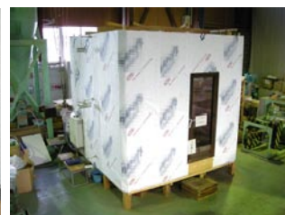
写真2 床暖房試験室
