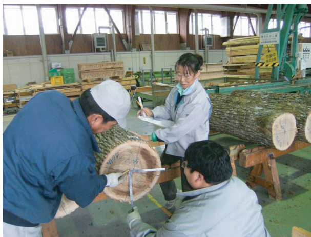
研究課題『道産広葉樹資源の育成に向けた人工 林材の材質調査』より、75年生ヤチダモ人工林 丸太の形質測定（利用部マテリアルグループ）
