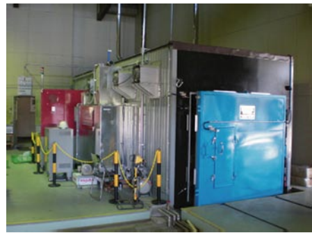
写真1 高周波熱気複合乾燥装置
