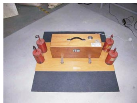
写真4 防音性の測定(上階側)
