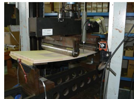
写真3 合板の曲げ試験
